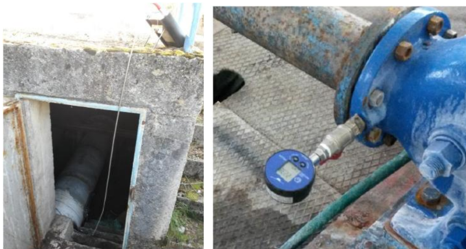
Fig. 6 Misure Portata e Pressione ISI Pietrasasso
