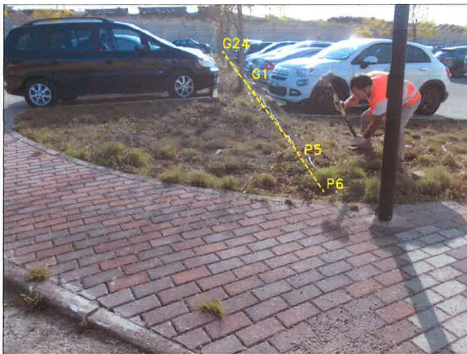
Foto 3: Postazione ed allineamento della Prova MASW.1 - particolare della battuta in onde di Rayleigh (componente verticale) nel punto di scoppio P5 -
