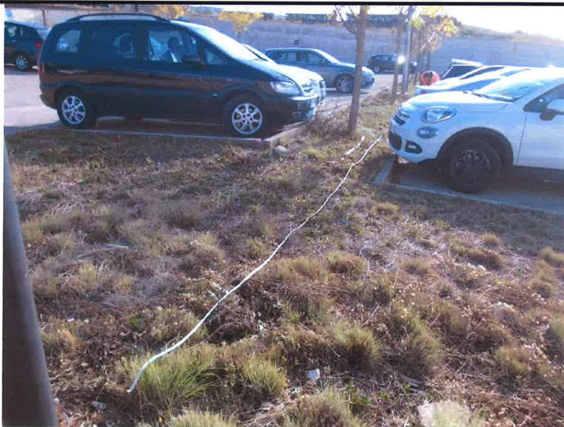
[Postazione ed allineamento del Profilo Sismico MASW.1]
