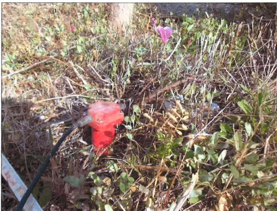
Foto 4: Postazione ed allineamento della Prova MASW.1 - geofono verticale a 4.5 Hz per le onde di Rayleigh in componente verticale -
